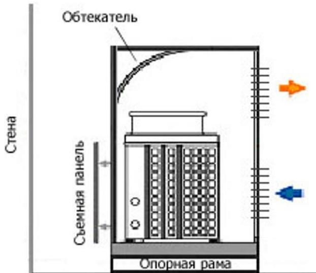
При работе наружного блока и его вентиляторов воздух проходит через конденсатор и, охлаждая его, нагревается на 10-15°C.
